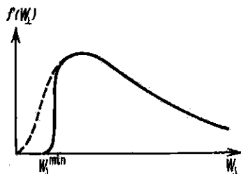
Рис. 30.12. Деформация функции распределения частиц по поперечной энергии при возрастании потенциала плазмы.
