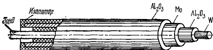
Рис. 18.5. Конструкция простого цилиндрического зонда.
