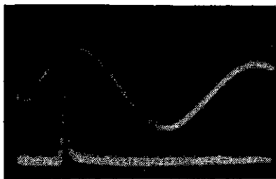
Рис. 35.9. Осциллограммы разрядного тока (вверху) и рентгеновского импульса (внизу). Длительность развертки 40 мксек.
